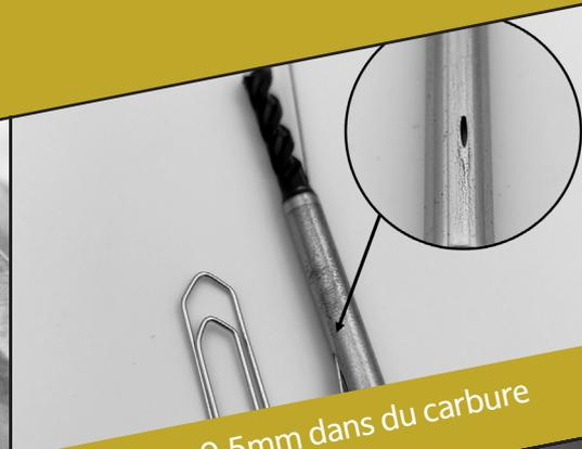
Trou de  $\varnothing$ 0,5mm dans du carbure
