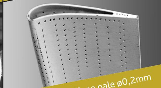
Multi-perçage d'une pale  $\varnothing$ 0,2mm
